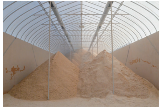
熱供給プラントのもみ殻供給ハウスに 積まれたもみ殻
